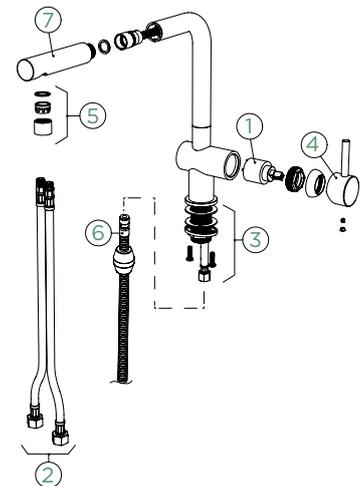
Hinweis: Diese Explosionszeichnung bildet die Hochdruck-Armatur mit deren Ersatzteilen ab. Für die Niederdruck-Armatur finden sie die Ersatzteilnummern in der Anleitung oder in unserem Shop.
