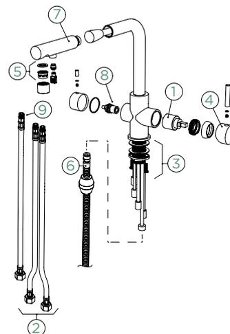
Nicht im SCHOCK Lieferumfang der Armatur enthalten: Filter inkl. Adapter und Schlauch der Kaltwasserleitung.
