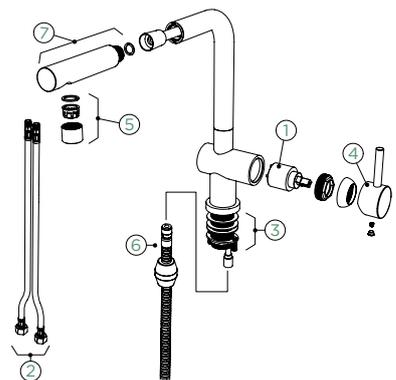
Hinweis: Diese Explosionszeichnung bildet die Hochdruck-Armatur mit deren Ersatzteilen ab. Für die Niederdruck-Armatur finden sie die Ersatzteilnummern in der Anleitung oder in unserem Shop.
