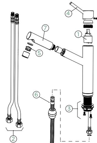
Hinweis: Diese Explosionszeichnung bildet die Hochdruck-Armatur mit deren Ersatzteilen ab. Für die Niederdruck-Armatur finden sie die Ersatzteilnummern in der Anleitung oder in unserem Shop.
