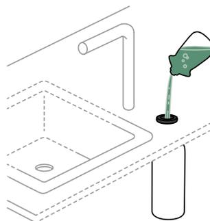
Hinweis: Einbau bei Arbeitsplattenstärken bis maximal 40mm möglich.
